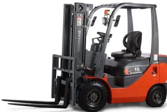
Slika 1. Izgled viljuškara novije izvedbe, dizel viljuškar za teret od 2,5 t [4]
